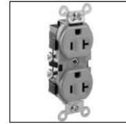
NEMA #5-20R duplex receptacle 125 VAC, 20 Amp
